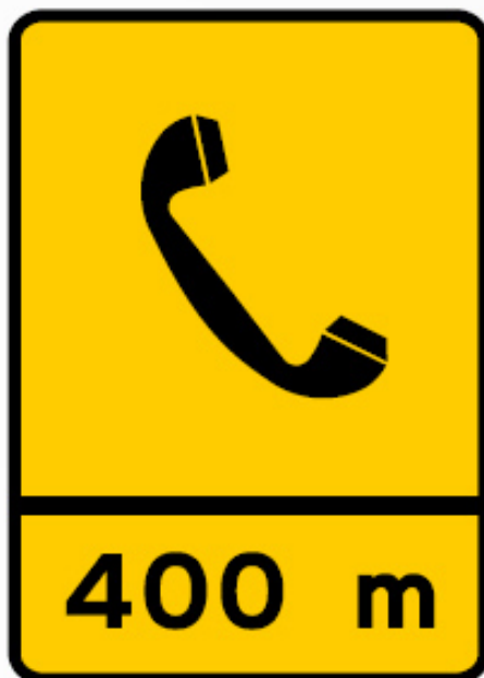
TV3/ST12 - Painel de indicação de posto de S.O.S.
