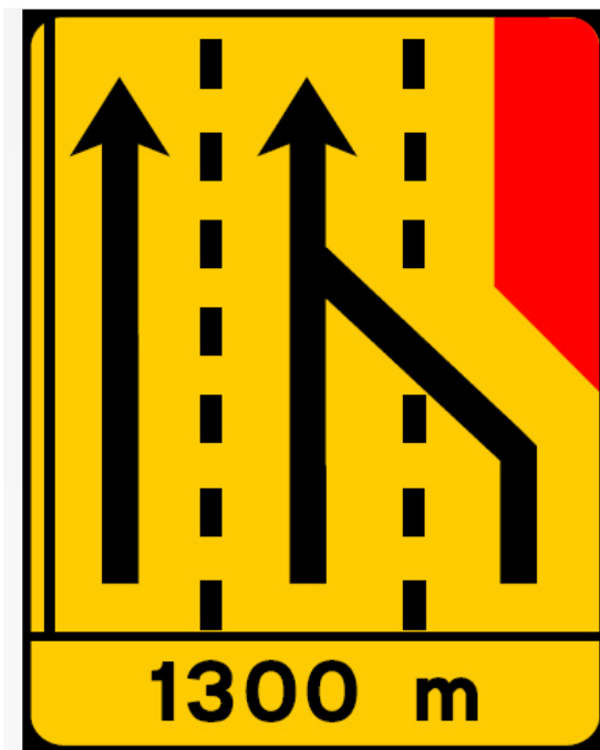
TD3 - Painel de estrangulamento à direita (3 vias) Desvio da via direita para a via central
