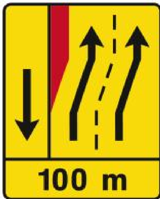
TD29 - Painel de desvio de direção (1×4) Desvio de 2 vias para as 2 vias adjacentes à direita
