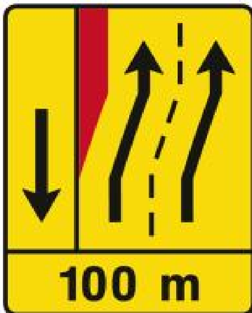
TD27 - Painel de estreitamento à esquerda (1x2+VL)
