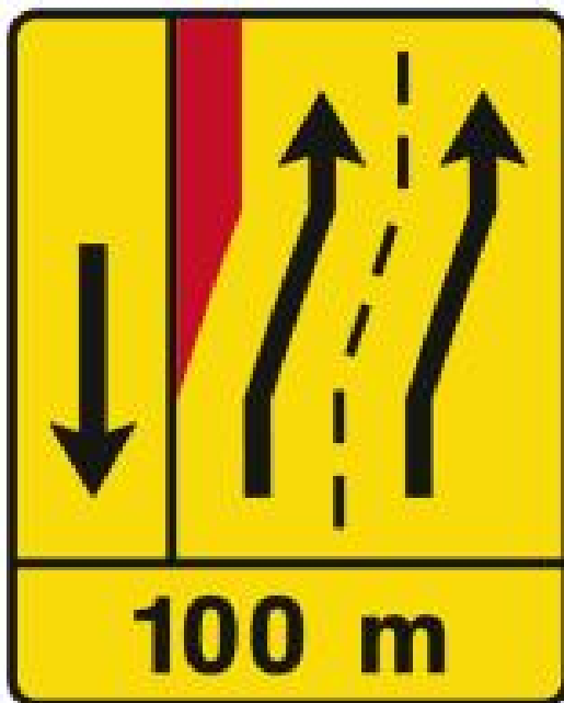
TD27 - Painel de estreitamento à esquerda (1×2+VL)
