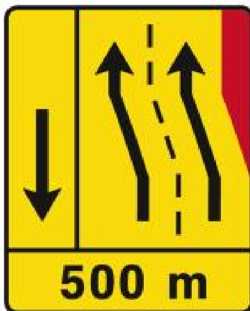
TD26 - Painel de estreitamento à direita (1×2+VL)
