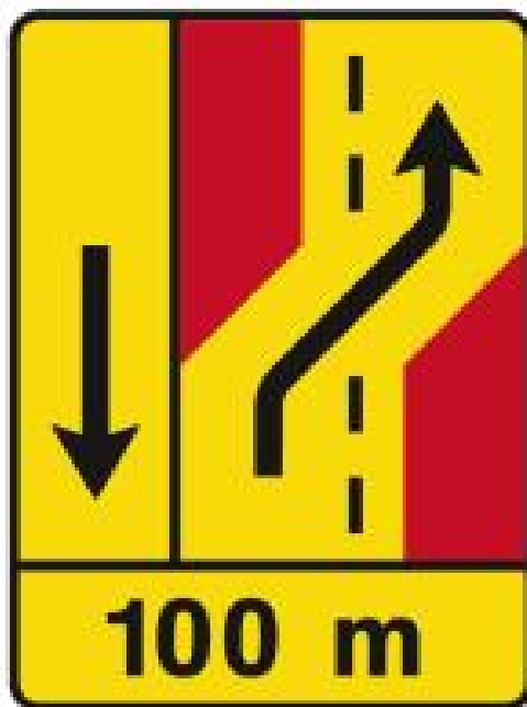
TD25 - Painel de desvio de direção (1×2+VL ou 1×4) Desvio de 1 via para a via adjacente à direita
