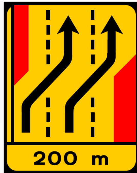
TD14 - Desvio de direção (3 vias) Desvio das vias esquerda e central para as vias direita e central
