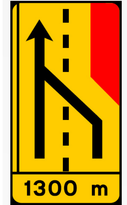
TD1 - ST2 - Painel de estrangulamento à direita (2 vias) Desvio da via direita para a via esquerda
