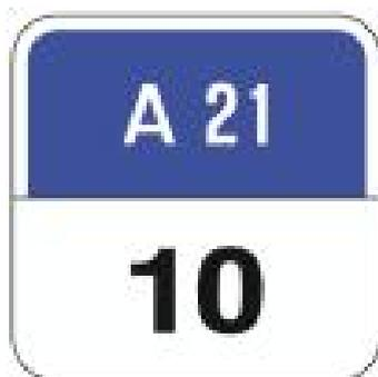
O3 - demarcação miriamétrica da via: devem conter a identificação da via e indicam a distância, por cada 10 km, ao seu ponto de origem
