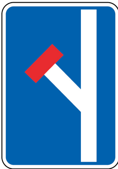
17a - Pré-sinalização de via sem saída
