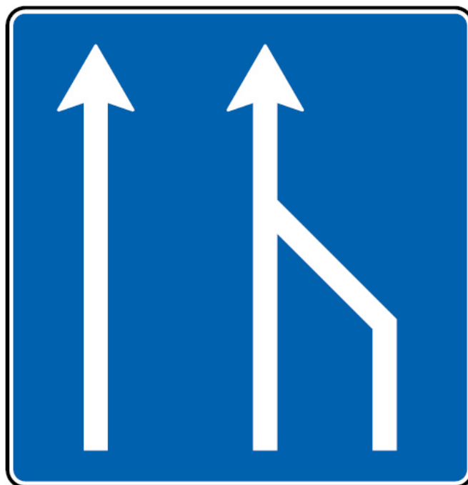
H32 - Supressão da via de trânsito
