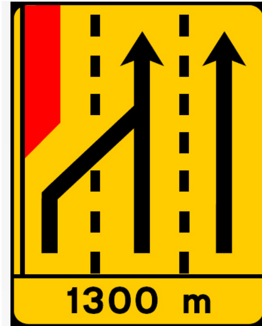
TD4 - Painel de estrangulamento à esquerda (3 vias) Desvio da via esquerda para a via central
