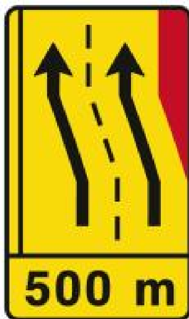
TD30 - Painel de estreitamento à direita (1×4)
