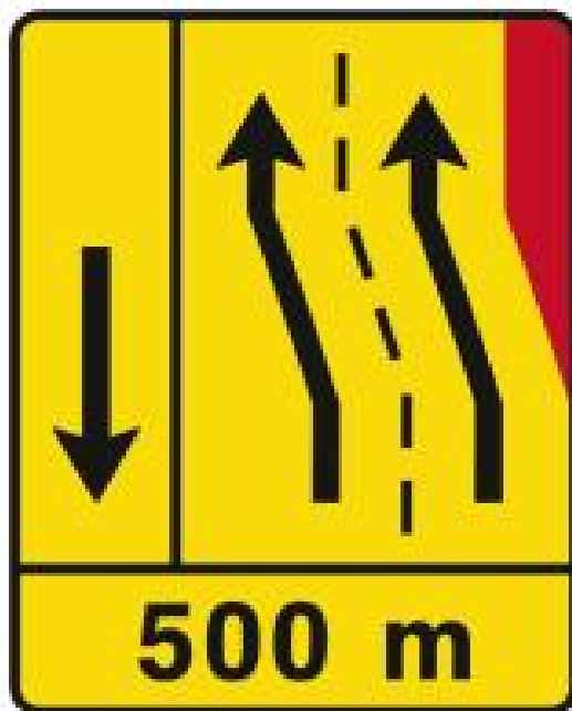
TD28 - Painel de desvio de direção (1×4) Desvio de 2 vias para as 2 vias adjacentes à esquerda
