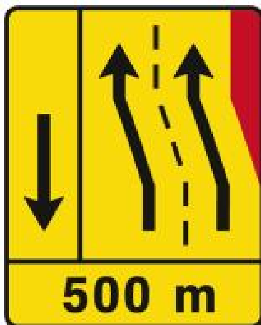
TD26 - Painel de estreitamento à direita (1x2+VL)
