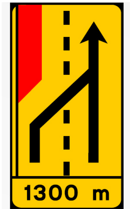
TD2 - Painel de estrangulamento à esquerda (2 vias) Desvio da via esquerda para a via direita
