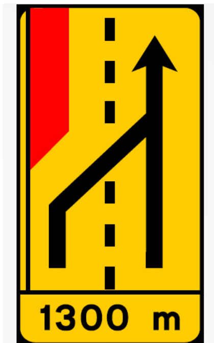
TD2 - Painel de estrangulamento à esquerda (2 vias) Desvio da via esquerda para a via direita
