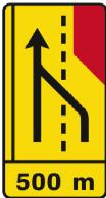
TD19 – Painel de estrangulamento à direita (1×4) Desvio da via direita para a via esquerda
