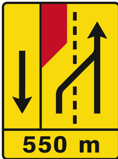
TD18 – Painel de estrangulamento à esquerda (1×2+VL) Desvio da via adjacente para a via de lentos
