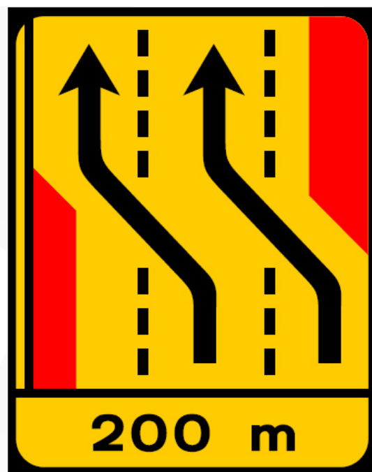
TD13 - ST4 - Desvio de direção (3 vias) Desvio das vias direita e central para as vias esquerda e central
