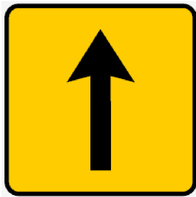
TC1 - ST1a - Painel indicativo da circulação 1 via na direção da circulação
