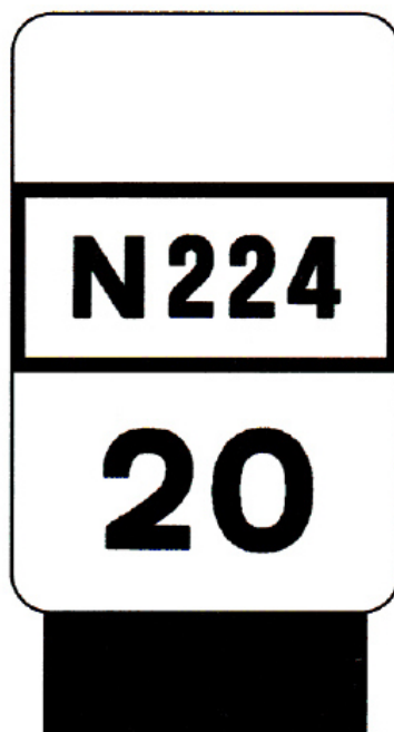
O3d - Demarcação miriamétrica da via
