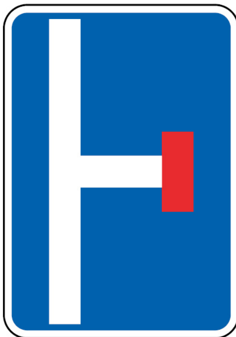
17b - Pré-sinalização de via sem saída
