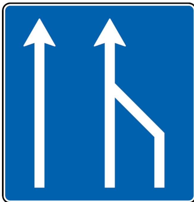
H32 - Supressão da via de trânsito
